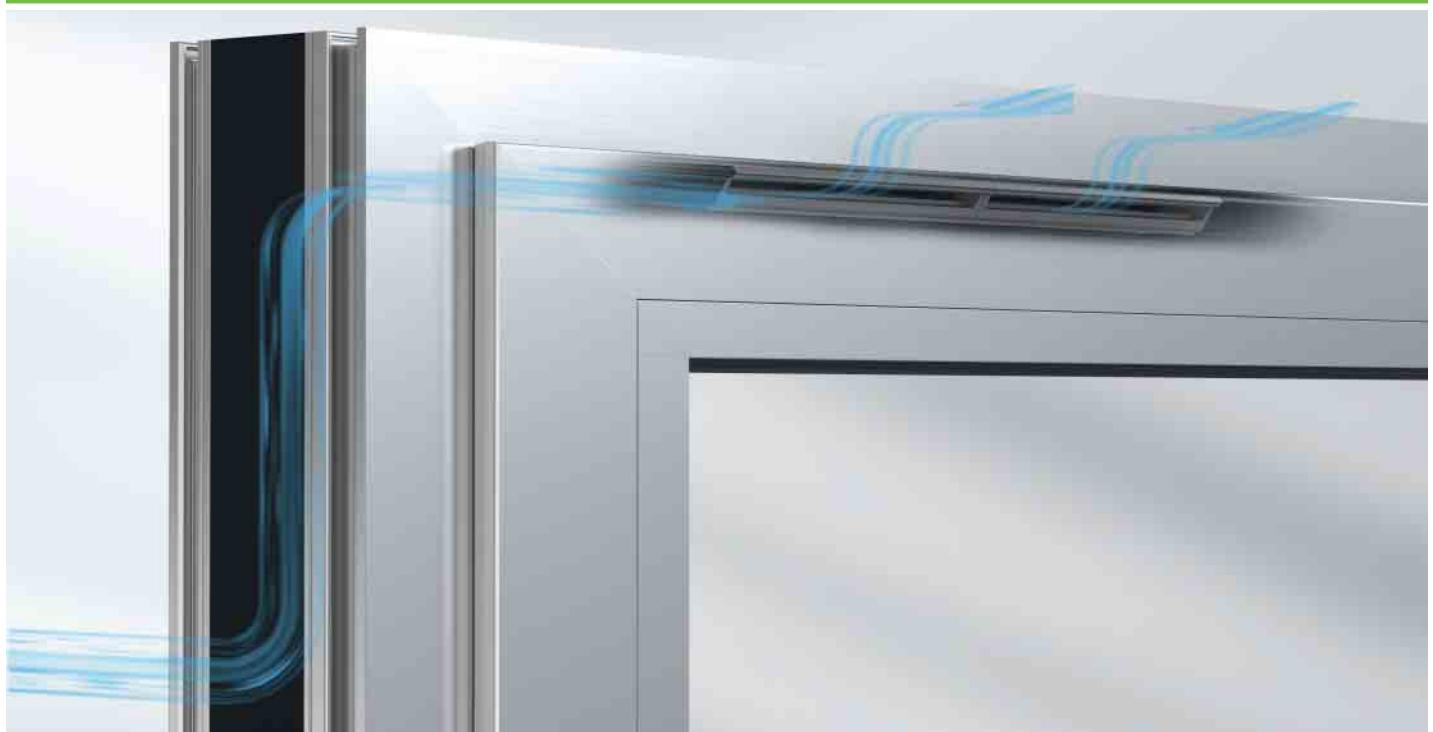
Schüco VentoAir regelt bedienerunabhängig die notwendige Lüftung inklusive Entfeuchtung in Wohngebäuden – gesundheitsgefährdende und teure Schimmelschäden können so vermieden werden. Das Prinzip basiert auf dem Druckdifferenzausgleich zwischen außen und innen. Dabei arbeitet der Lüfter rein mechanisch: Bei stärkeren Windgeschwindigkeiten regelt die Lüfterklappe automatisch die einströmende Luft ab, unangenehme Zuglufterscheinungen werden so verhindert.
